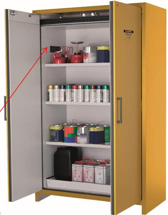
Saídas de ar superiores e inferiores, obrigatórias de acordo com EN 14470-1. Na presença de fogo (70°C), a válvula tipo borboleta fecha automaticamente. As saídas de ar incluem tampões e interruptores de chamas.
